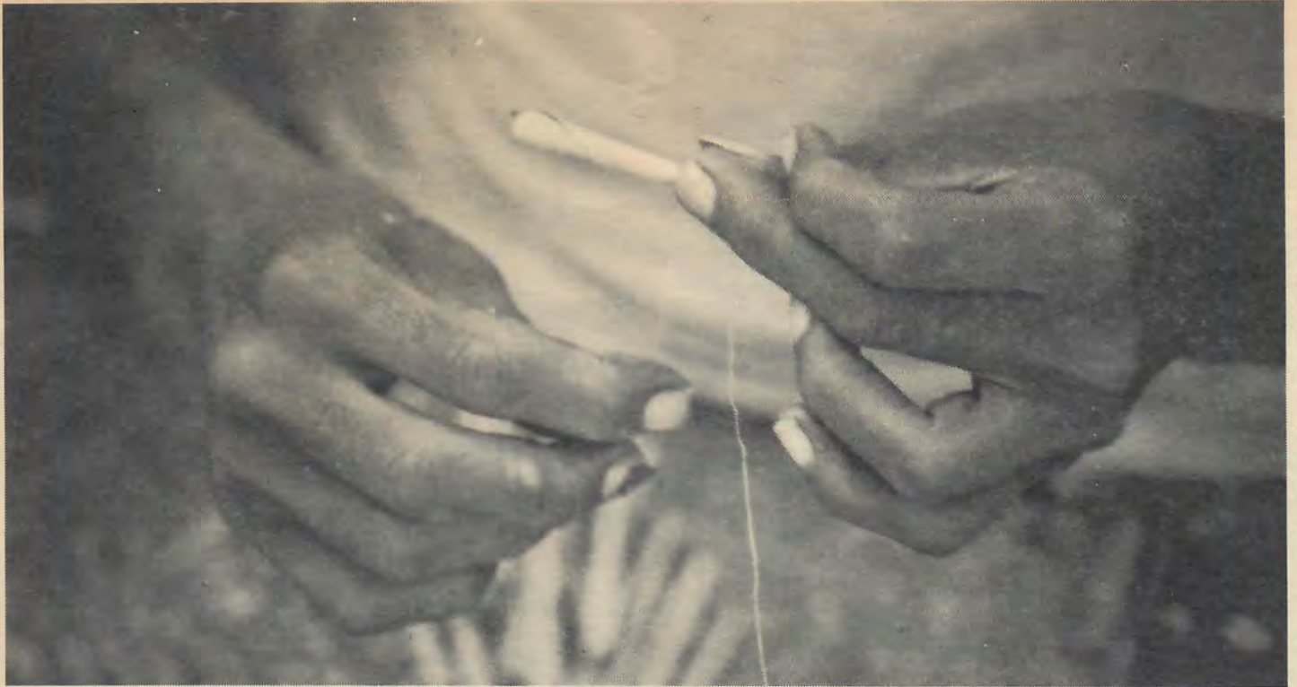
Att rulla en bidi är ett pillgöra. Det gäller att rulla in en lagom mängd tobak i ett blad, försegla bägge ändar och binda en bomullstråd runt om. Arbetet är inte tungt men bidiarbetarnas arbetsförhållanden är ändå de sämsta tänkbara. (Foto Kalle Kjellman)
